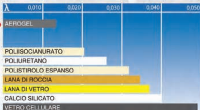
RAFFRONTO CONDUTTIVITÀ TERMICA TRA MATERIALI ISOLANTI \lambda = W/(m^{\circ}K)
